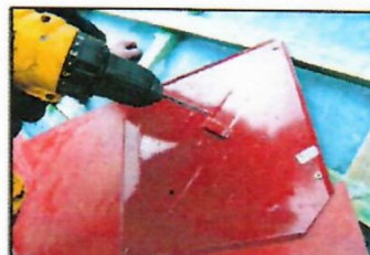
popis 3 Předvrtání pro šrouby vrtákem o průměru 2,5 -3 mm, dodávané k podpěře.
