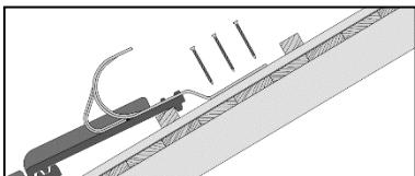
Montáž do krovky přes kontralatě nebo bednění s předvrtáním třemi dodávanými drážkovými pozinkovanými hřebíky o rozměrech 6 x 100 mm.
